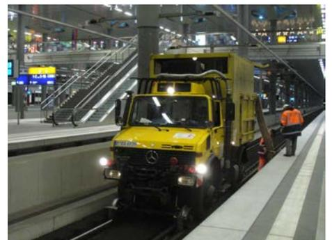
Gleisreinigung mit Saugaufbau
