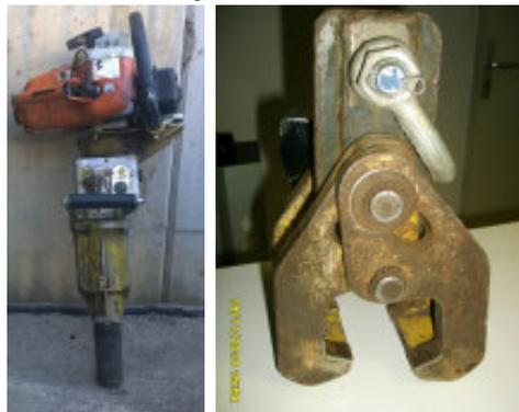
**Kleingeräte: Schienenzange, Stopfgeräte, Schwellenschraubmaschine, Steinsäge, Kettensäge, etc.**
